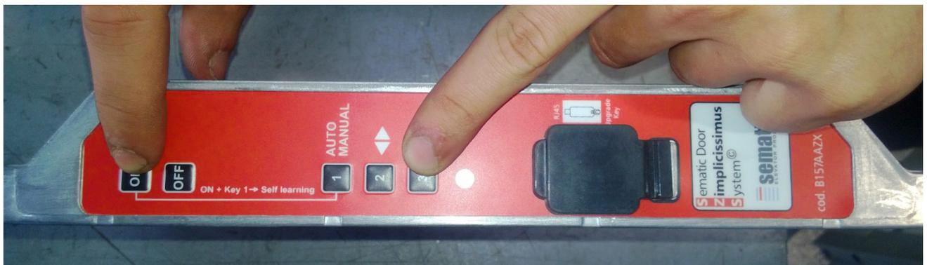
3. Halten Sie die Taste 3 (><) gedrückt und drücken Sie gleichzeitig die Taste ON (EIN), dann lassen Sie beide Tasten los.
