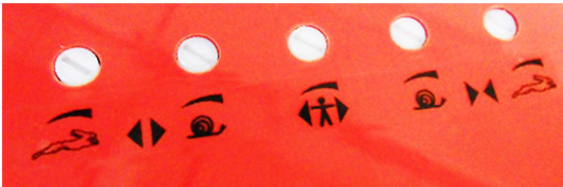
Das Bewegungsumkehrsystem ist ein internes System. Die Wiederöffnung der Türen bei vorhandenem Hindernis wird ausschließlich durch das Türsteuergerät geregelt und das Wiederöffnungssignal wird über die IM-Kontakte an die Aufzugssteuerung gemeldet (Kontakte Ibis 4 Arbeitskontakte, Kontakte 2 bis 4 Ruhekontakte).
