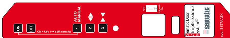
Для проверки правильной работы открывателя дверей перед подключением сигналов с основного контроллера лифта предусмотрена возможность открывания и закрывания двери с помощью кнопок <> и ><, расположенных на передней панели привода двери.
