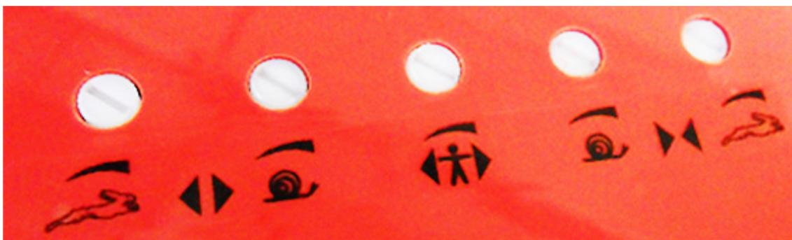
Система реверса является ВСТРОЕННОЙ, повторное открывание дверей при обнаружении помехи управляется только контроллером двери, а сигнал о повторном открывании дверей отправляется на основной контроллер лифта через контакты IM (нормально замкнутые контакты 1-4, нормально разомкнутые контакты 2-4).
